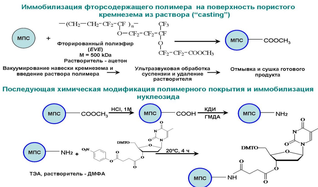
Рисунок 22 - Получение EVE -содержащего носителя для твердофазного синтеза олигонуклеотидов.
