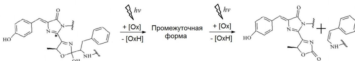
Рис. 9. Предложенная схема фотопреобразования PSmOrange. [Ox] и [OxH] - молекулы окислителя и восстановленного окислителя, соответственно. По [5] с изменениями.
