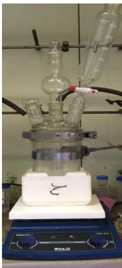
Рисунок 4.22 – Реактор для нанесения ФП-покрытия на поверхность частиц объемно-пористого кремнезема методом кастинга.
