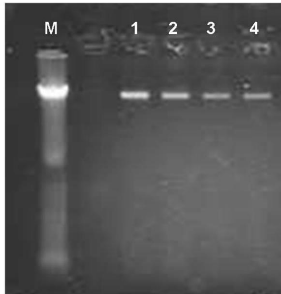
Рисунок 5.4 - Электрофореграмма элюатов, полученных при выделении ДНК из E. coli с использованием картриджей с ПФБД-содержащими сорбентами, синтезированными на основе кремнезёмов с различной пористостью: М – ДНК-маркер, 1 – Trisoror™-500-ПФБД; 2 – МПС-250ГХ-ПФБД; 3- МПС-1150ГХ-ПФБД; 4 - МПС-2000ГХ-ПФБД (цифры, проставленные в марках носителей, обозначают средний диаметр пор носителя в ангстремах) [137].
