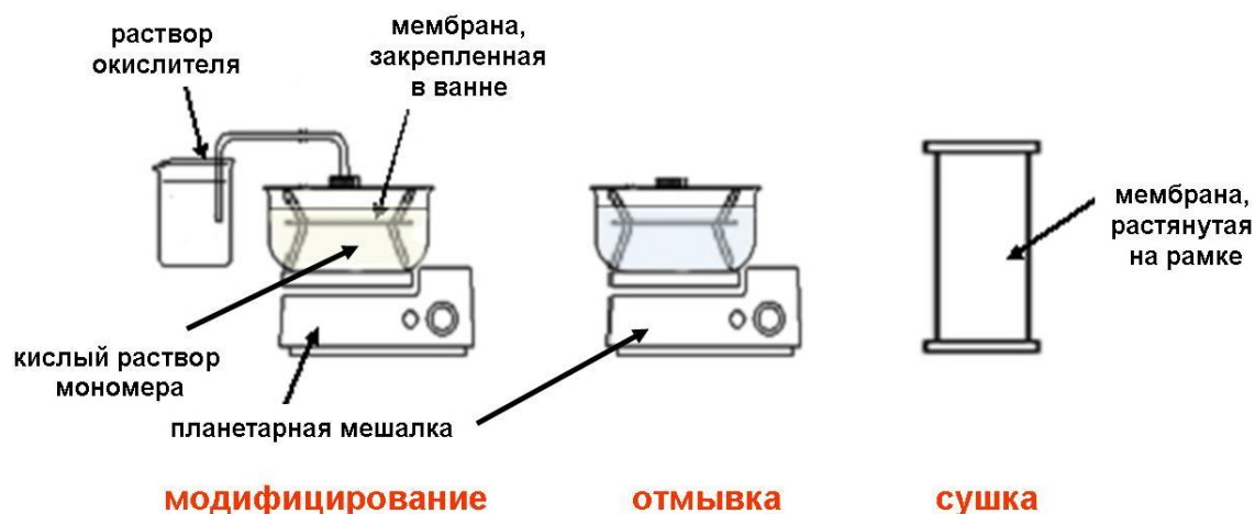
Рисунок 4.32 – Схема процесса модифицирования поверхности полимерных синтетических мембран ПАНИ-покрытием.
