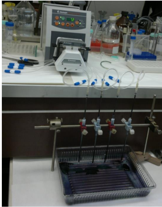
Рисунок 4.26 – Установка для одновременного модифицирования ПАНИ-нанослоями внутренней поверхности МК (длиной до 30 см) с помощью многоканального перистальтического насоса.
