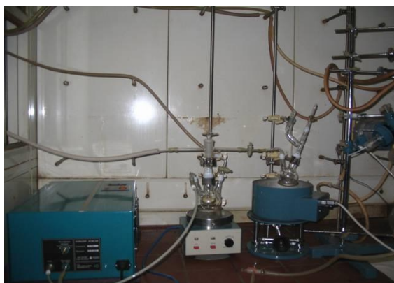
Рисунок 4.19 – Установка для обработки сыпучих носителей озонowo-воздушной смесью, генерируемой озонатором ОГВК-20К.
